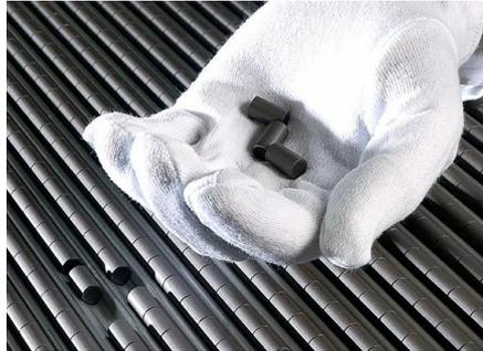
Uranpellets wie sie in Leichtwasserreaktoren der Generation II zur Stromproduktion verwendet werden.
